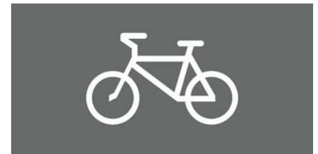
Рисунок 4. Форма горизонтальной дорожной разметки 1.23.2 и 1.23.3 по ГОСТ Р 51256–2018
