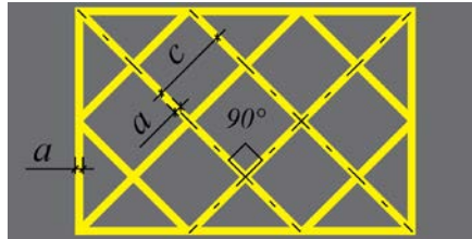
Рисунок 1. Горизонтальная разметка 1.26 по ГОСТ Р 51256–2018 «Технические средства организации дорожного движения. Разметка дорожная. Классификация. Технические требования»
