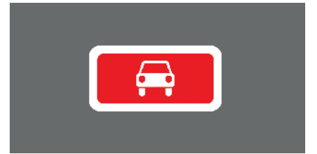
Рисунок 7. Проект изображения (формы) горизонтальной дорожной разметки 1.24.7 — дублирование дорожного знака «Стоянка только транспортных средств дипломатического корпуса»
