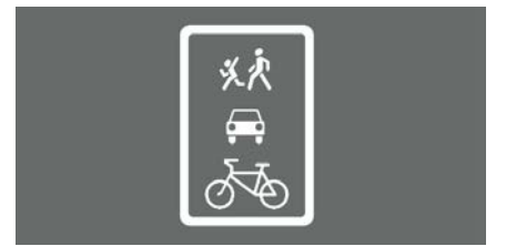
Рисунок 6. Проект изображения (формы) горизонтальной дорожной разметки 1.24.6 — дублирование дорожного знака «Велосипедная зона»
