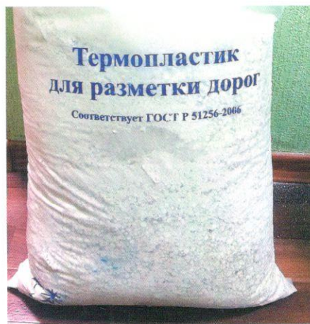
Рис. 4. Ссылка на маркировке термопластика для дорожной разметки на несуществующий нормативный документ
