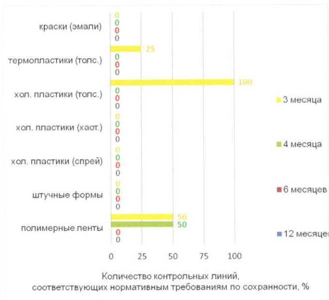
Рис. 8. Количество контрольных линий, соответствующих всем нормативным требованиям, на автомобильной дороге К-12 Новосибирск – Томск, км 30 (с асфальтобетонным покрытием). Для полимерных лент период эксплуатации на два месяца меньше: 1, 2, 4 и 10 месяцев соответственно. На рисунке применены следующие сокращения:
